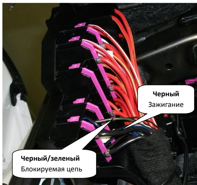
1. Запрограммируйте функцию 3-9 в значении (2), для управления аварийной сигнализацией автомобиля по цепи кнопки аварийной сигнализации (стр. 4). В заводском значении функции управление аварийной сигнализацией будет осуществляться по CAN-шине, но при этом не будут мигать задние поворотники.
