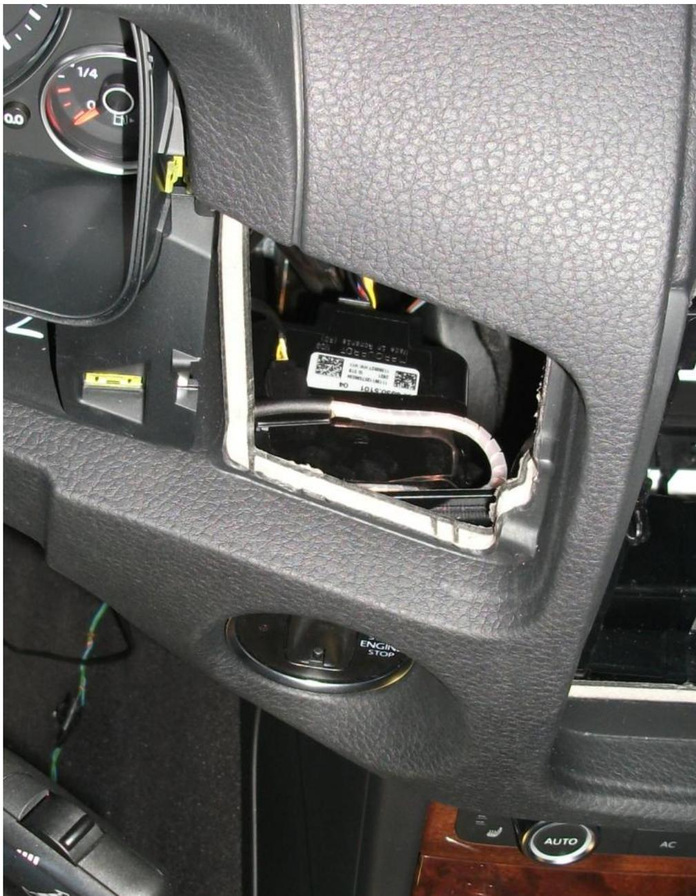
Внешнюю катушку обходчика иммобилайзера Scher-Khan VP-3 расположить непосредственно на модуле замка зажигания, сверху, (на фото вид от зеркала заднего вида).
