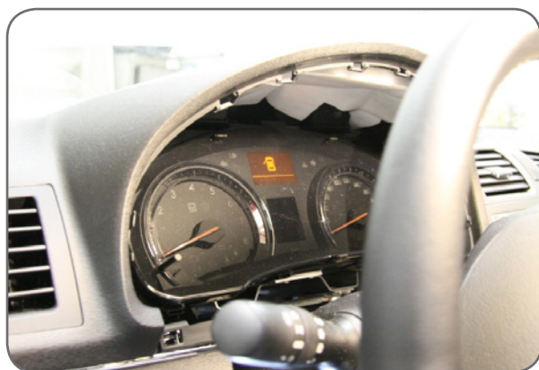
Фото 2.1. Снятие облицовки приборного щитка
