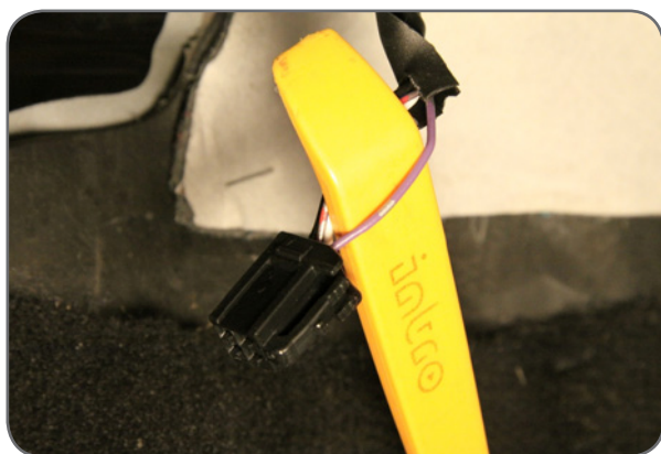
Фото 12. Провод контроля тормоза (фиолетовый)
