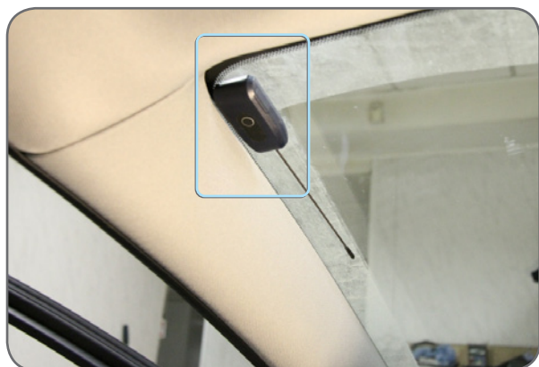
Фото 4.3. Антенна на лобовом стекле
