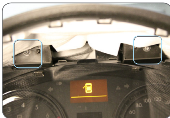
Фото 2.2. Крепление приборного щитка (2 самореза)
