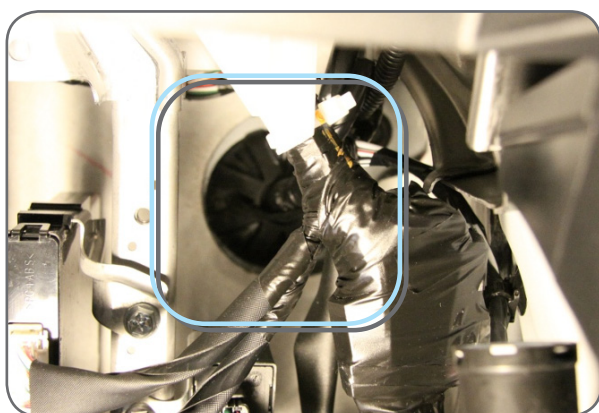
Фото 5.5. Штатный уплотнитель (вид из салона)
