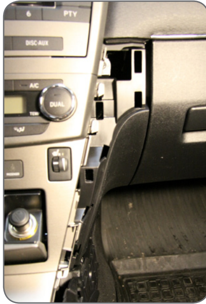
Фото 3.5. Снятие боковых накладок
