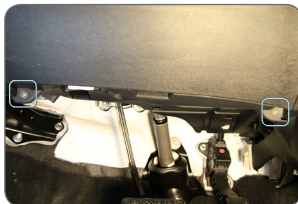
Фото 1.2. Крепление подторпедника (2 самореза)
