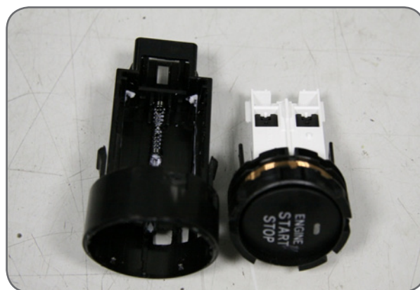
Фото 18.4. Полностью разобранный кнопка
