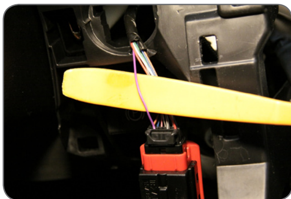
Фото 14. Провод запуска-глушения автомобиля (фиолетовый)
