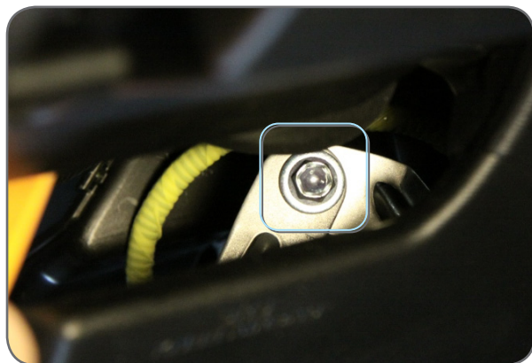
Фото 1.3. Крепление аирбэга (болт М6)
