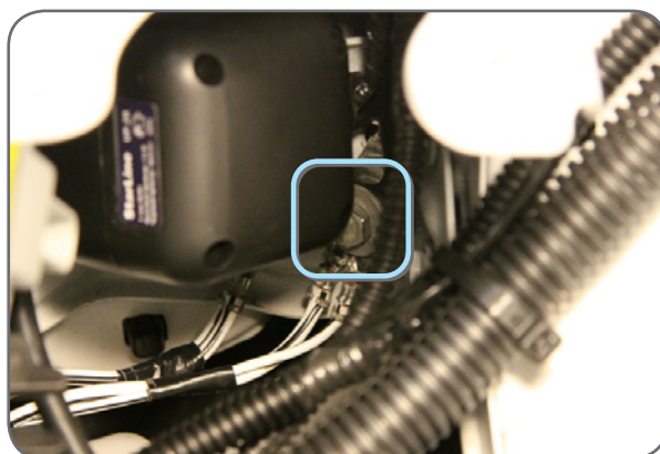
Фото 5.2. Сирена (крепление на штатный болт М6)
