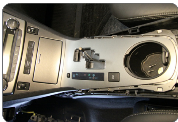
Фото 3.3. Снятие верхних накладок
