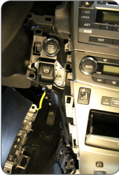
Фото 3.4. Снятие боковых накладок
