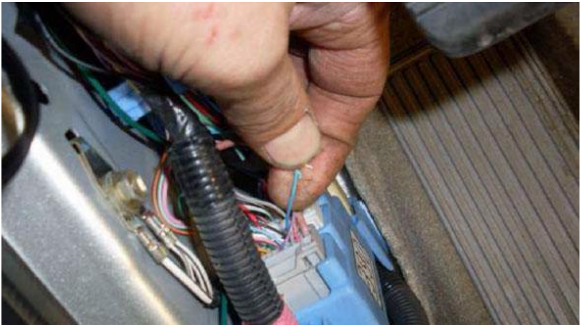
Концевик задней левой двери - черный. Все концевики подключаем через диоды!
