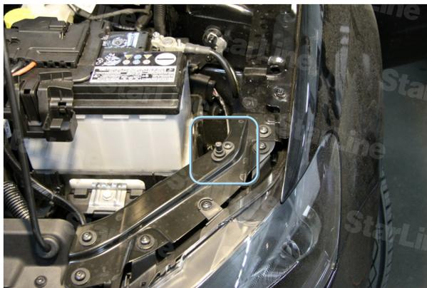
Фото 4.3. Концевик капота. Отрезать 2 деления
