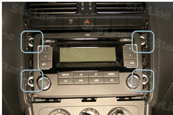
Фото 2.1. Снятие облицовки и саморезы
