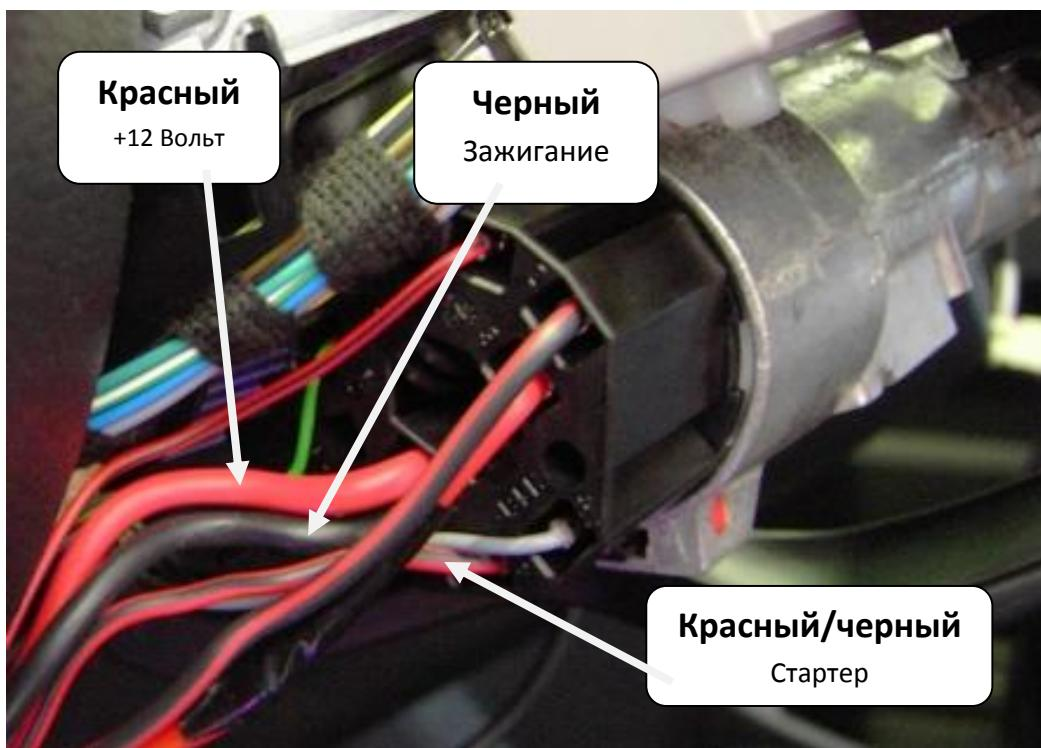
Блокировку, для препятствования несанкционированному запуску двигателя, можно выполнить, разорвав провод «стартер», красный/черный выходящий с клеммы 50, замка зажигания. Соединения выполнить в соответствии с приведенной ниже схемой.
