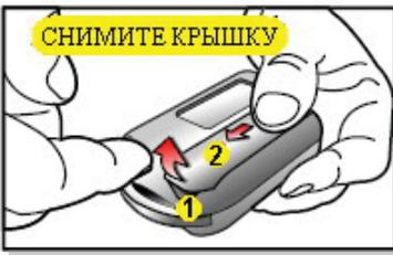
Для замены батареи питания откройте крышку батарейного отсека с обратной стороны пульта, как показано на рисунке – сначала немного приподняв край, а затем сдвинув крышку в сторону кольца для ключей. Выньте старый элемент, затем вставьте новый, соблюдая полярность подключения. Закройте крышку в обратной последовательности.
