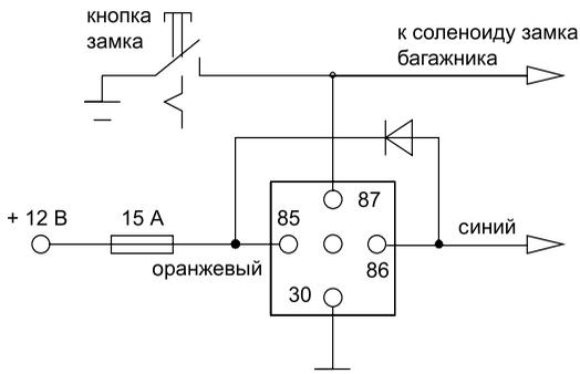
Темно-синий провод системы представляет собой слаботочный транзисторный выход, поэтому он должен использоваться только для включения внешнего реле.
